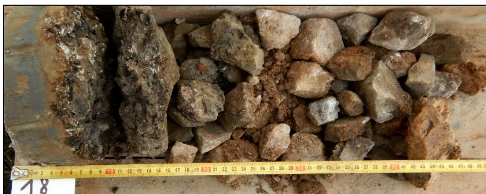
Foto 2,3 : je patrná tloušťka a vrstvení asfaltového krytu a hrubě kamenitý charakter podkladní vrstvy
